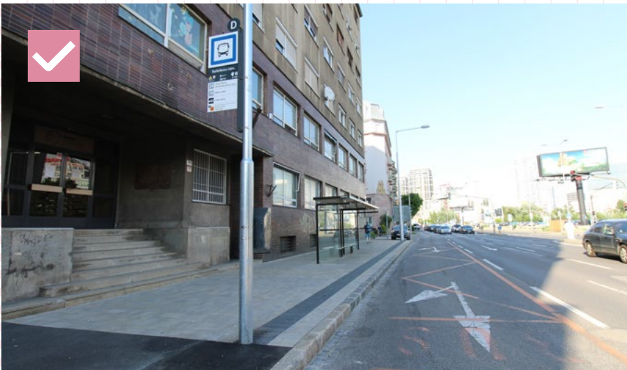
07 Dláždená plocha nástupišta betónovou dlažbou na chodníku s asfaltovým povrchom. Hmatateľné povrchy sú nevhodne vyhotovené. Varovný pás by mal začínať 0,5 m od stožiaru, na ktorom je umiestnený označník, rovnako chýba signálny pás. Zastávka Šafárikovo námestie, Bratislava
