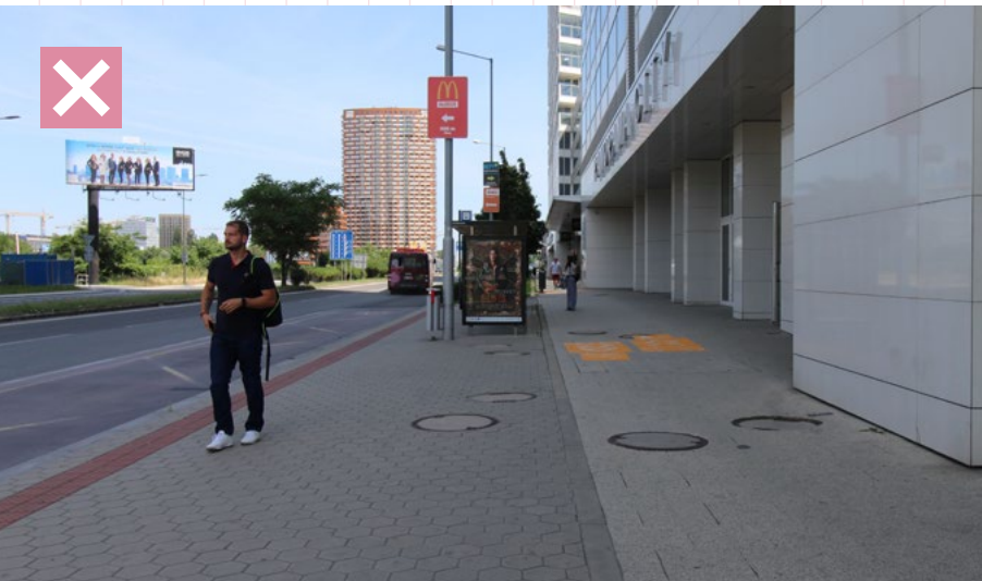
09 Nástupište je nevhodne vydláždené iným typom dlažby ako chodník za nástupišťom. Použité dlažby nie sú v materiálovom, farebnom ani rozmerovom súlade. Rovnako nie je vhodné používať výraznú červenú farbu hmatateľných povrchov. Zastávka Landererova, Bratislava
