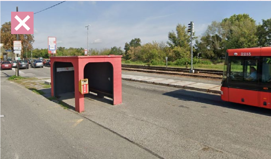
10 Zastávka nemá vybudované vyvýšené nástupište ani prístup. Je potrebné vybudovať celé nástupište spolu s prístupovým chodníkom výškovo oddeleným od komunikácie. Zastávka Stn. Podunajské Biskupice, Bratislava
